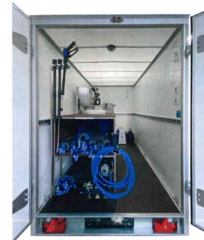
Mobiles Kreislaufsystem zur Schmutzwasseraufbereitung verbaut in einem Anhänger. (Fotos: Hermes Fassadenreinigung GmbH)
